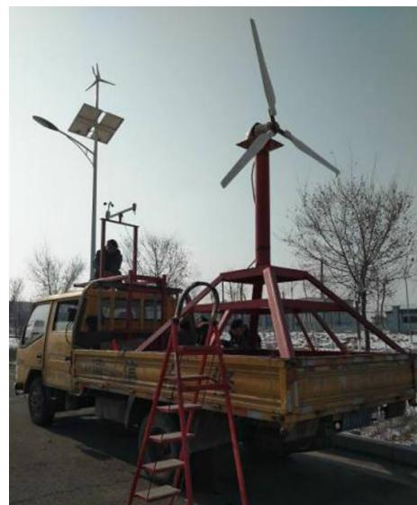
图 3 300 W 风电机组车载测试
