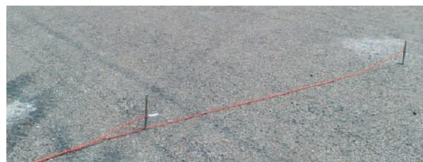
图 1 温度传感器埋置示意图
