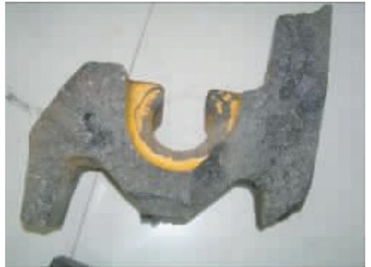
图4 端头断裂图
