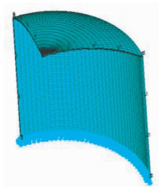
图2 LNG预应力储罐计算模型
