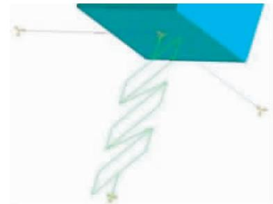
图4 隔震垫单元图
