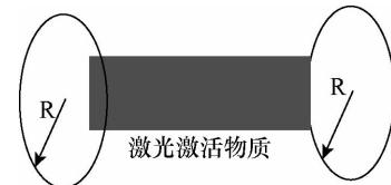
图 1 圆平面镜腔
